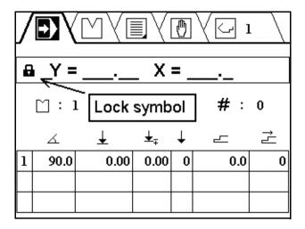
Ob diese Tastensperre zur Verfügung steht, hängt von den Maschineneinstellungen ab.
