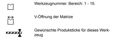
Die hier programmierte Dicke spielt während der Produktprogrammierung eine wichtige Rolle. Der Wert der V-Öffnung dient nur als Bezugswert und wird für Berechnungen nicht verwendet. Unten im Werkzeugfenster steht eine Tabelle mit den Winkelund den Y-Achsenwerten.
