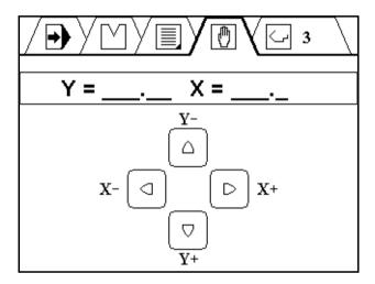
In diesem Fenster können die X- und die Y-Achse von Hand mit den Pfeiltasten bewegt werden. Dies ist nur möglich, wenn die Steuerung nicht in Betrieb ist. In diesem Fenster wird angegeben, wie eine Achse mit einer bestimmten Pfeiltaste bewegt werden kann.
