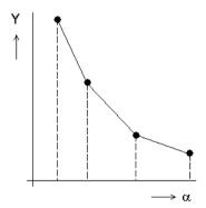
Wenn weniger als vier Sollwerte vorliegen, programmieren Sie die benötigten Sollwerte und belassen Sie den Y-Wert für die ungültigen Sollwerte bei Null. Die Winkelwerte in der ersten Spalte müssen in ansteigender Reihenfolge programmiert werden.
