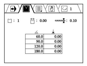
Ein Werkzeug wird an der Steuerung programmiert, indem einige grundlegende Werkzeugwerte eingegeben werden. Diese Werte werden für die automatische Berechnung der Biegetiefe während der Biegeprogrammierung verwendet.
