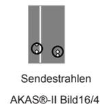
**Feinjustage** Die Senderhalterung muss so um die Längs- und Querachse geschwenkt werden, bis die Laserstrahlen parallel zum Oberwerkzeug verlaufen.
