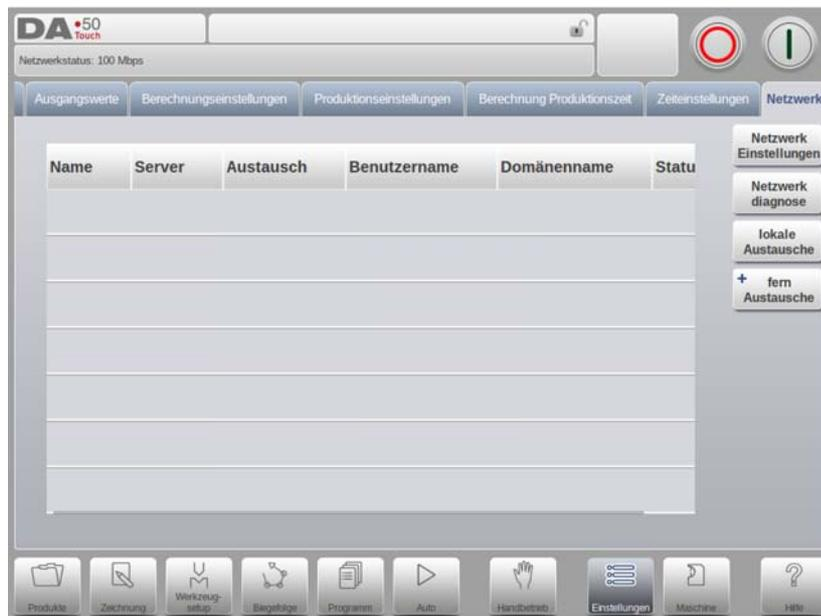
Wenn die Netzwerkoption in Ihrer CNC-Steuerung installiert ist, verfügen Sie über zusätzliche Einstellungsparameter in der Einstellungs-Betriebsart der Steuerung. In der Einstellungs-Betriebsart finden Sie den Tab Netzwerk mit Seiten und Parametern für Netzwerkeinstellungen, zur Netzwerkdiagnose sowie für lokale Freigaben und Fernfreigaben.
