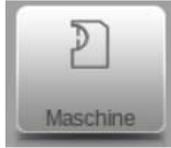
Durch Drücken der Navigationstaste Maschine wird die Steuerung in die Maschinenbetriebsart umgeschaltet.
