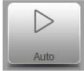
Durch Drücken der Navigationstaste Auto wird die Steuerung in den Automatikbetrieb geschaltet.
