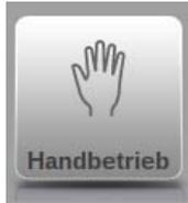
Durch Drücken der Navigationstaste Handbetrieb wird die Steuerung in den Handbetrieb geschaltet.
