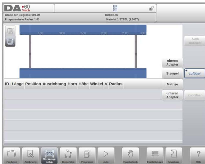
Wenn ein Werkzeug ausgewählt wurde (z. B. ein Stempel), wird es mit der maximal verfügbaren Länge in die Maschine eingefügt.
