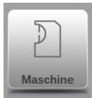
Benutzereinstellungen und Präferenzen anwendbar für die Maschine, den Werkzeugbestand einschließlich Werkzeug-Editor, die Sicherung/Wiederherstellung von Daten, Informationen zur Softwareversion usw.
