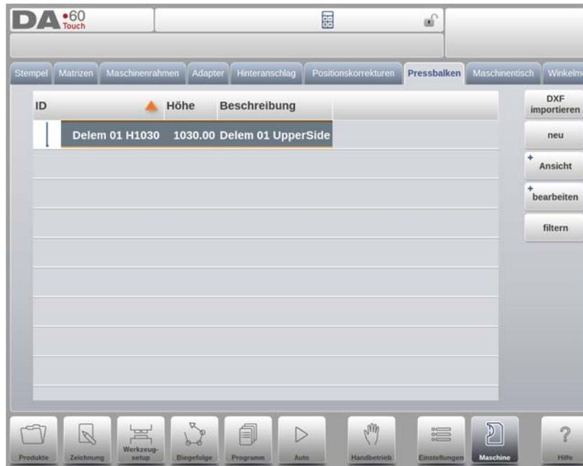
Die Formen Ihrer Maschine werden auf die gleiche Weise wie bei Stempeln und Matrizen gezeichnet. Genauso wie bei den Werkzeugen ist die rechte Seite der Zeichnung die Position des Hinteranschlags der Maschine.
