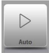
Durch Drücken der Navigationstaste Auto wird die Steuerung in den Automatikbetrieb geschaltet.
