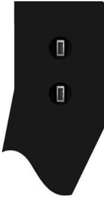
Auf der rechten Seite der Steuerung stehen zwei USB-Anschlüsse zur Verfügung für den Anschluss externer Geräte, wie Memorysticks, oder einer externen Tastatur / Maus.
