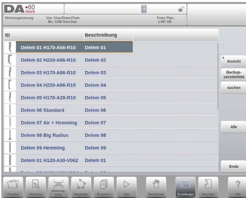
Mit diesem Menü kann eine Sicherungsdatei aller Werkzeuge in der Steuerung angelegt werden: für Stempel, Matrizen oder Maschinenformen. Die Verfahren zur Anfertigung einer Sicherungsdatei von Werkzeugen lassen sich mit denen zur Erstellung einer Sicherungsdatei für Produkte vergleichen.
